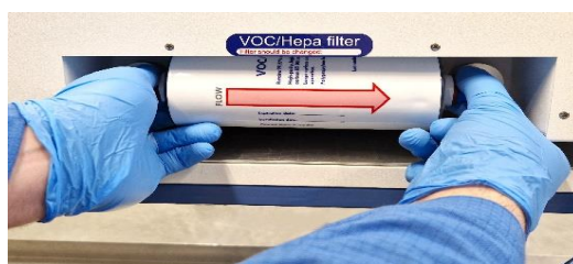
Εικόνα 12.2 Διαδικασία εισαγωγής και αφαίρεσης φίλτρου VOC/HEPA
